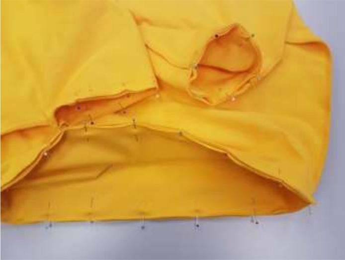
Cose la banda para la cintura y los puños con una puntada overlock de 4 hilos, asegurándote de retirar todos los alfileres antes de que la cuchilla llegue hasta ellos.
