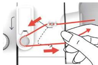
> Вытяните конец нитки через одно из внутренних отверстий шпульки и насадите пустую шпульку на моталку.
