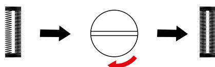
> Чтобы уменьшить плотность стежка левого гусеничного шва петли, вращайте ручку регулировки баланса против часовой стрелки.
