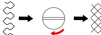
> Чтобы уменьшить плотность стежка эластичной строчки, вращайте ручку регулировки баланса против часовой стрелки.
