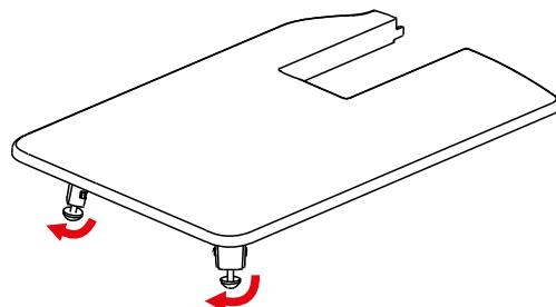
> Надвиньте приставной столик слева направо на рукавную платформу, чтобы защелкнулся фиксатор.
